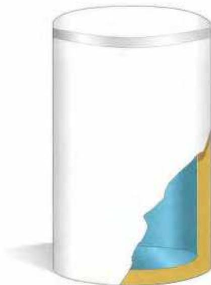
Par exemple, un ballon de 1000 litres maintenu à 70 °C et placé dans une pièce non chauffée présente des déperditions équivalentes à environ 1500 litres de mazout par an si le ballon n'est pas isolé, 200 litres s'il est isolé avec 4 cm de laine minérale et d'environ 70 litres s'il est isolé avec 10 cm de polyuréthane.
