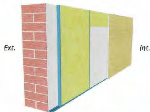
**i** Le matériau isolant est appliqué sur la face intérieure. Il est recouvert d'une finition avec pare-vapeur.
