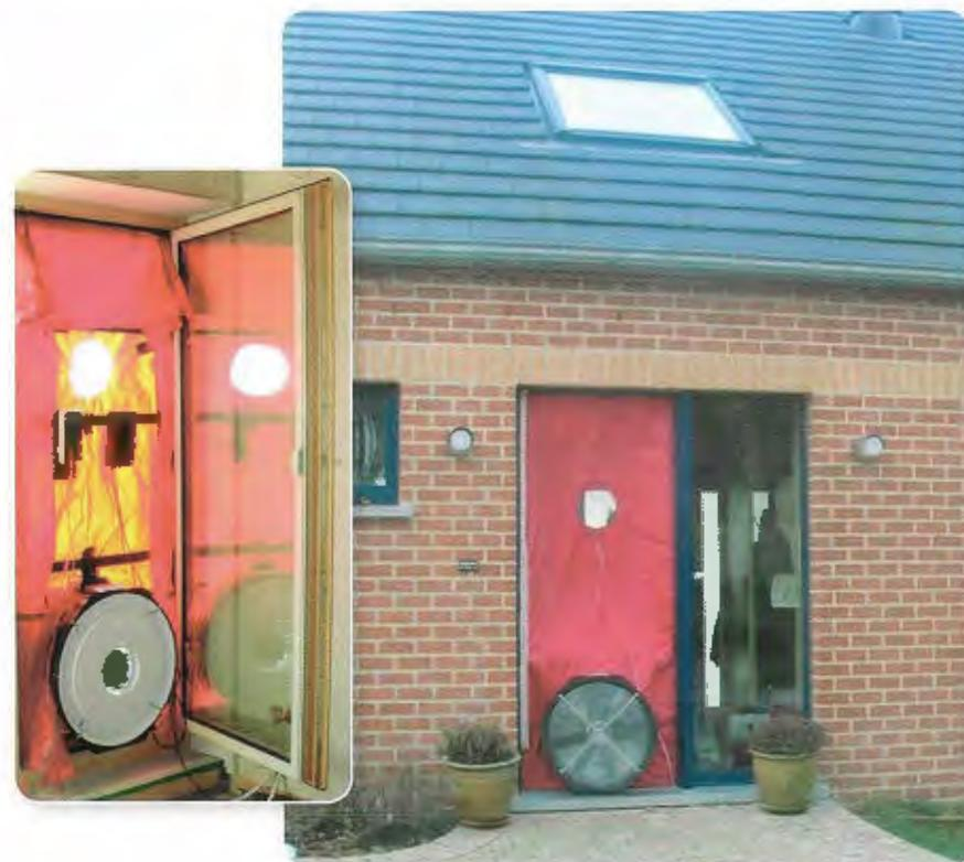
Il est recommandé de le réaliser **après** la pose de l'isolation et du pare-vapeur (ou freine-vapeur) et, **avant** de placer les panneaux de finition afin de pouvoir corriger tout défaut éventuel. Une seconde mesure réalisée après pose des finitions donnera généralement de meilleurs résultats.
